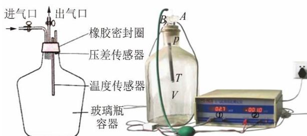
绝热膨胀法测量空气比热容比
